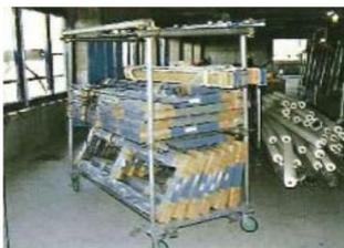
連結棒の組み合わせで一時保管場所として活用(足場単管を利用した2段式台車)
