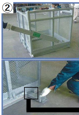
② 側面左右に収納している爪を抜き 下部左右に、それぞれセット
